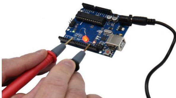
شکل 19. چرخه کار اندازه گیری شده در این شکل 95.6 درصد است.
