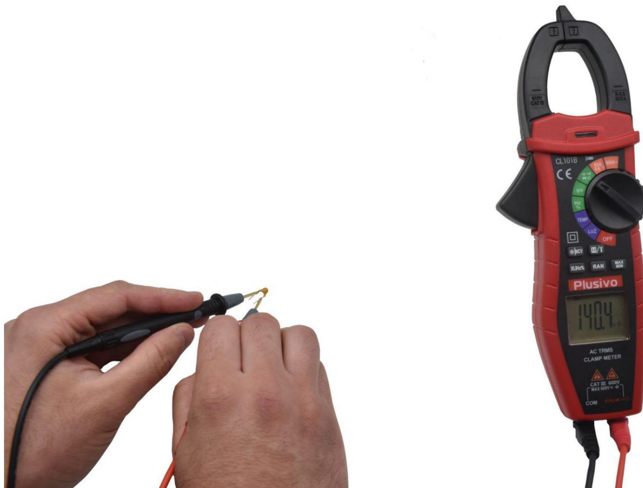
شکل 8. ظرفیت اندازه گیری شده در این شکل 140.4 nF است
