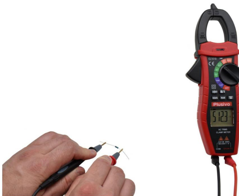
شکل 32. مقاومت اندازه گیری شده در این شکل 512.3 \Omega است
