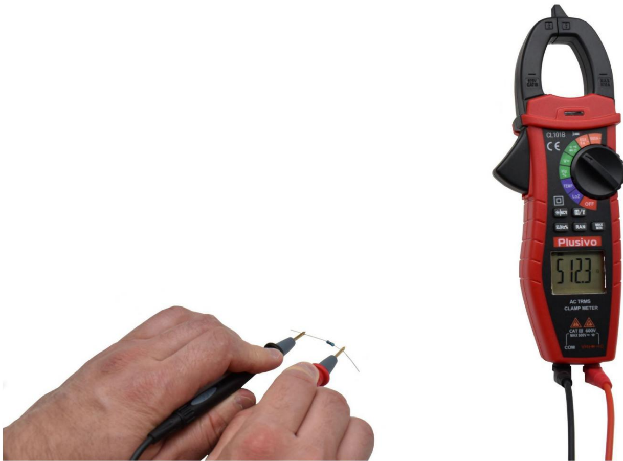
شکل 30. مقاومت اندازه گیری شده در این شکل 512.3 \Omega است
