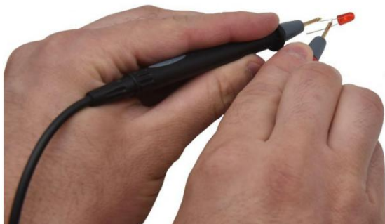
شکل 12. ولتاژ رو به جلو اندازه گیری شده در این شکل 1.874 ولت است
