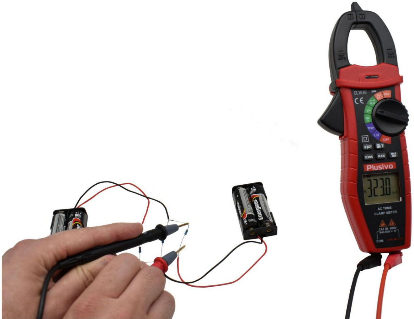
شکل 36. ولتاژ اندازه گیری شده در این شکل 323.0 میلی ولت DC است.
