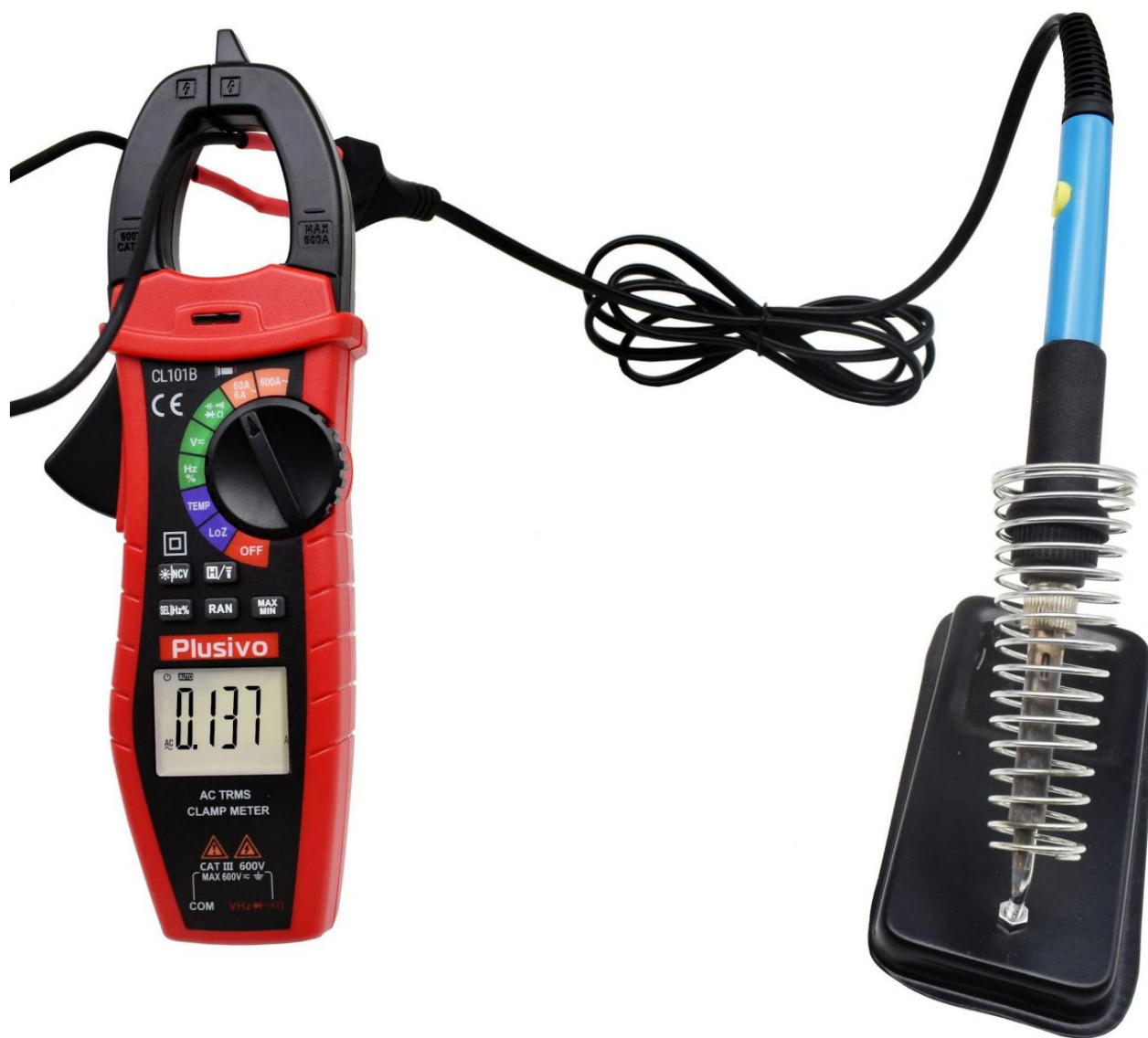
شکل 3. جریان اندازه گیری شده در این شکل AC 0.137 A است
