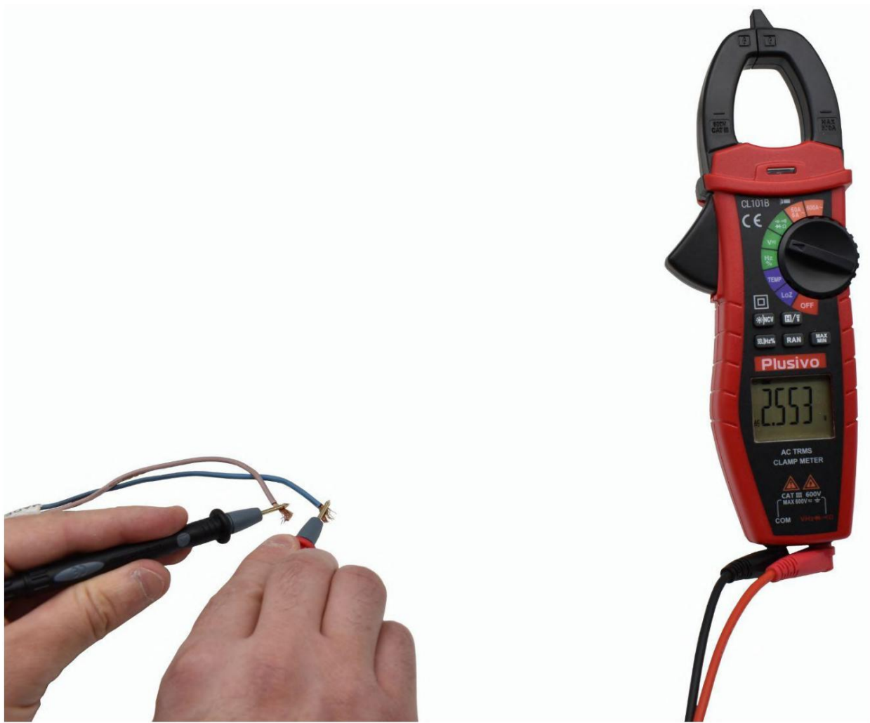
شکل 27. ولتاژ اندازه گیری شده در این شکل AC 2.553 V است
