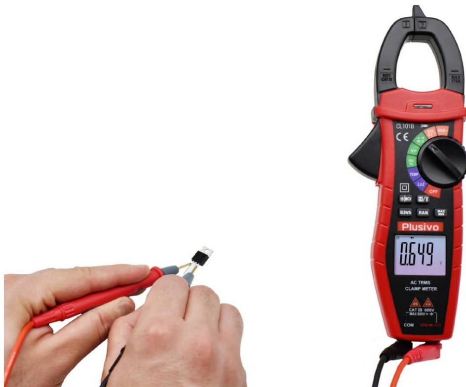
شکل 46. ولتاژ رو به جلو اندازه گیری شده در این شکل 0.649 V 60 است.
