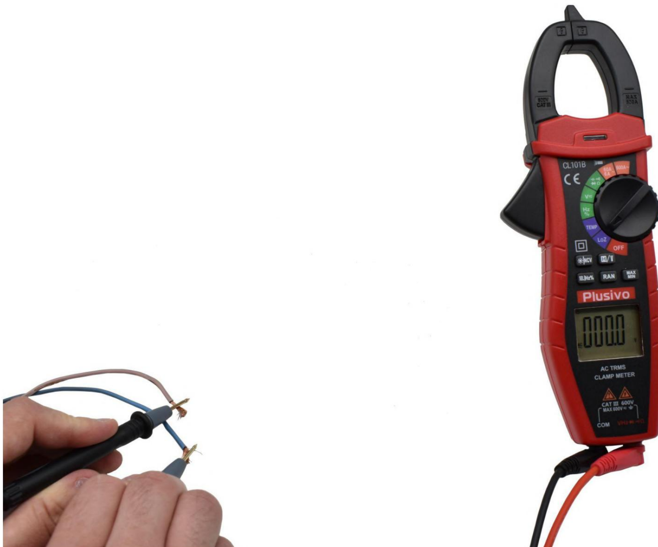
شکل 28. ولتاژ اندازه گیری شده در این شکل 0.0 ولت AC است
