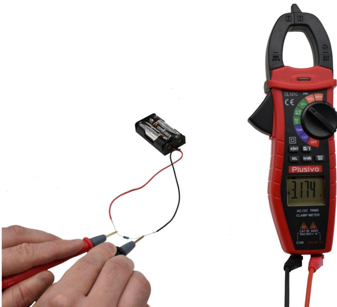
شکل 31. ولتاژ اندازه گیری شده در این شکل 3.174 ولت DC است
