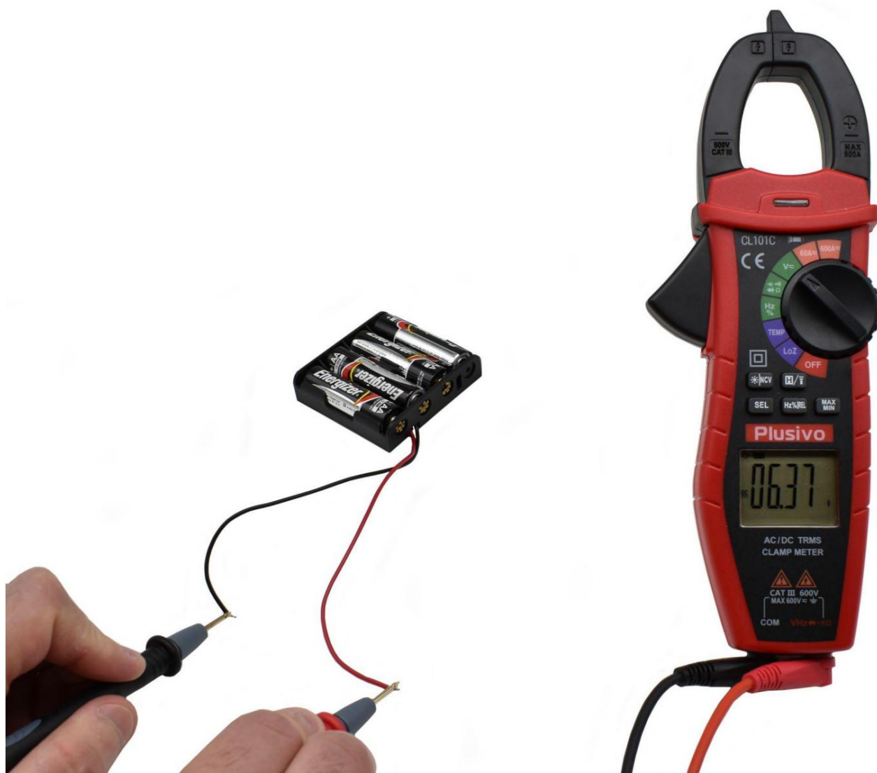
شکل 23. ولتاژ اندازه گیری شده در این شکل 6.37 ولت DC است
