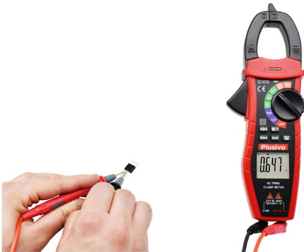
شکل 45. ولتاژ فوروارد اندازه گیری شده در این شکل 0.647 ولت است
