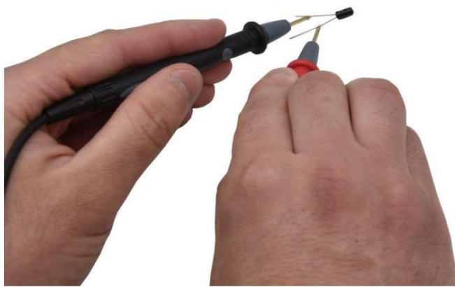
شکل 9. ظرفیت اندازه گیری شده در این شکل 37.27 \mu\text{F} است
