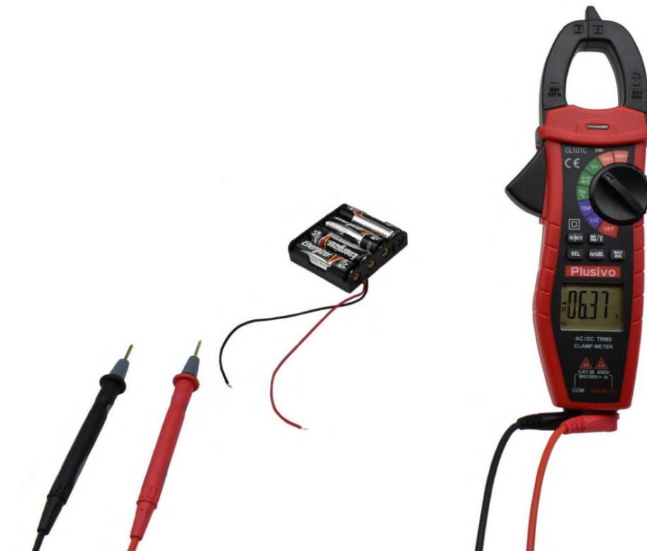
شکل 25. ولتاژ اندازه گیری شده در این شکل 6.37- V DC است
