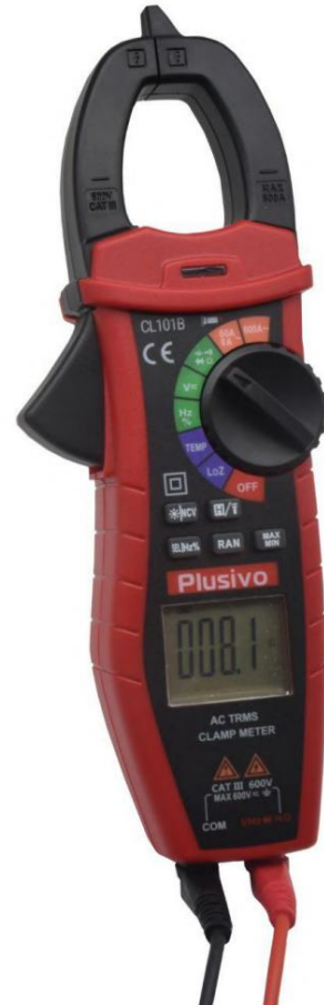
شکل 7. مقاومت اندازه گیری شده در این شکل 8.1 \Omega است
