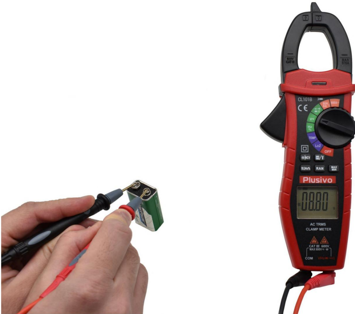
شکل 40. ولتاژ اندازه گیری شده در این شکل 8.80 ولت DC است
