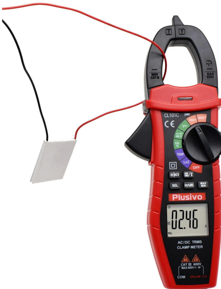
شکل 4. جریان اندازه گیری شده در این شکل DC 2.46 A است
