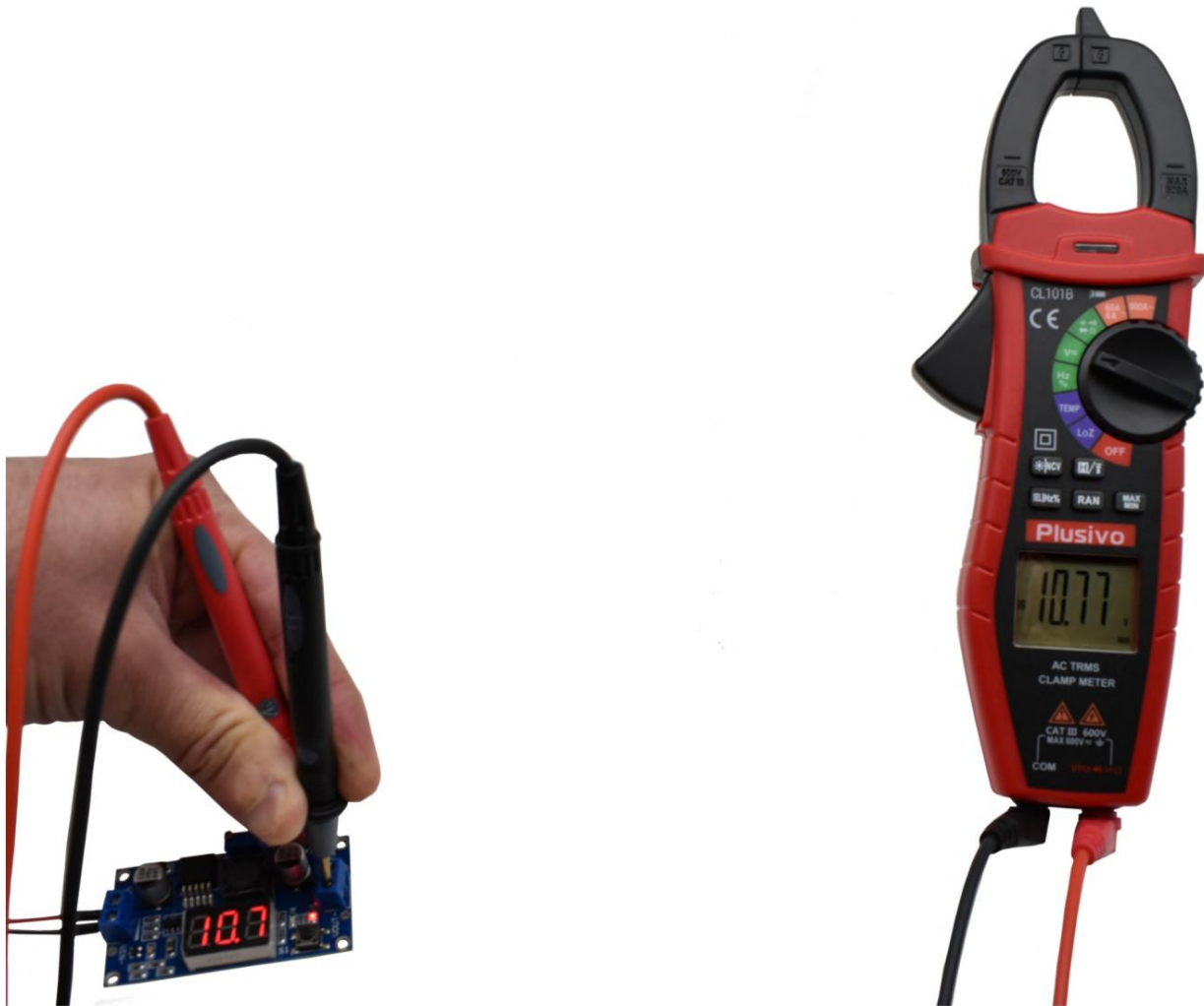
شکل 20. ولتاژ MIN در این شکل 10.77 ولت DC است
