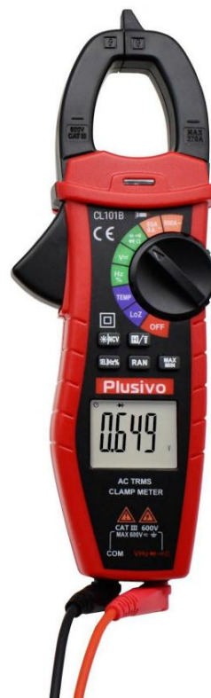
شکل 48. ولتاژ رو به جلو اندازه گیری شده در این شکل 0.649 V است.
