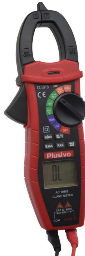
شکل 11. اگر پروب ها را اشتباه وصل کنید، صفحه نمایش "OL" را نشان می دهد.
