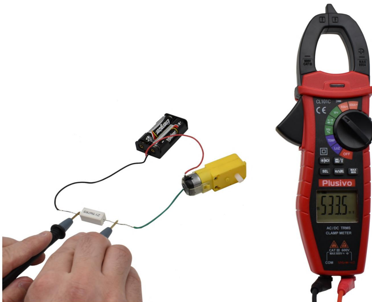
شکل 38. ولتاژ اندازه گیری شده در این شکل 533.5 میلی ولت DC است.
