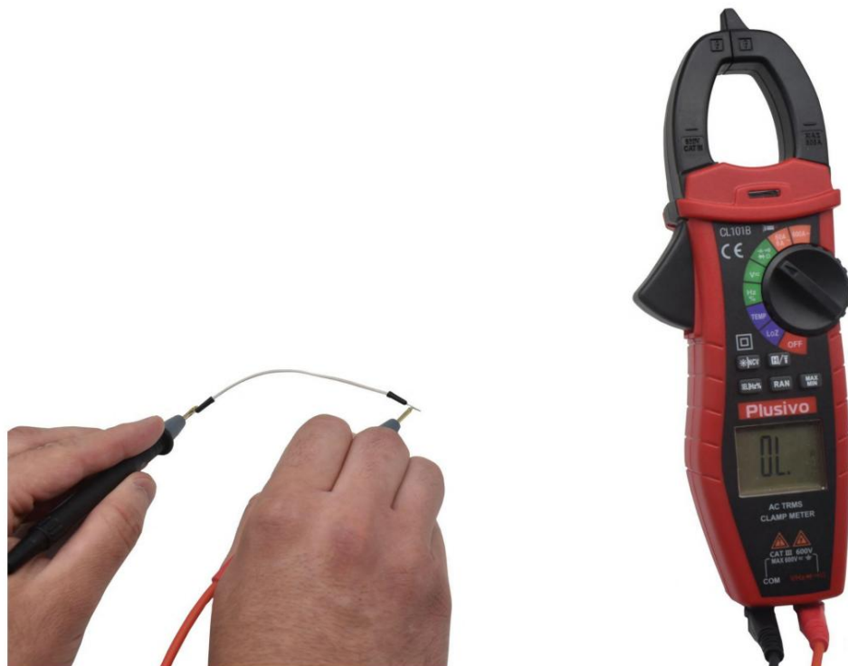
شکل 14. اگر یک مسیر هادی شکسته شود، گیره سنج بوق نمی دهد
