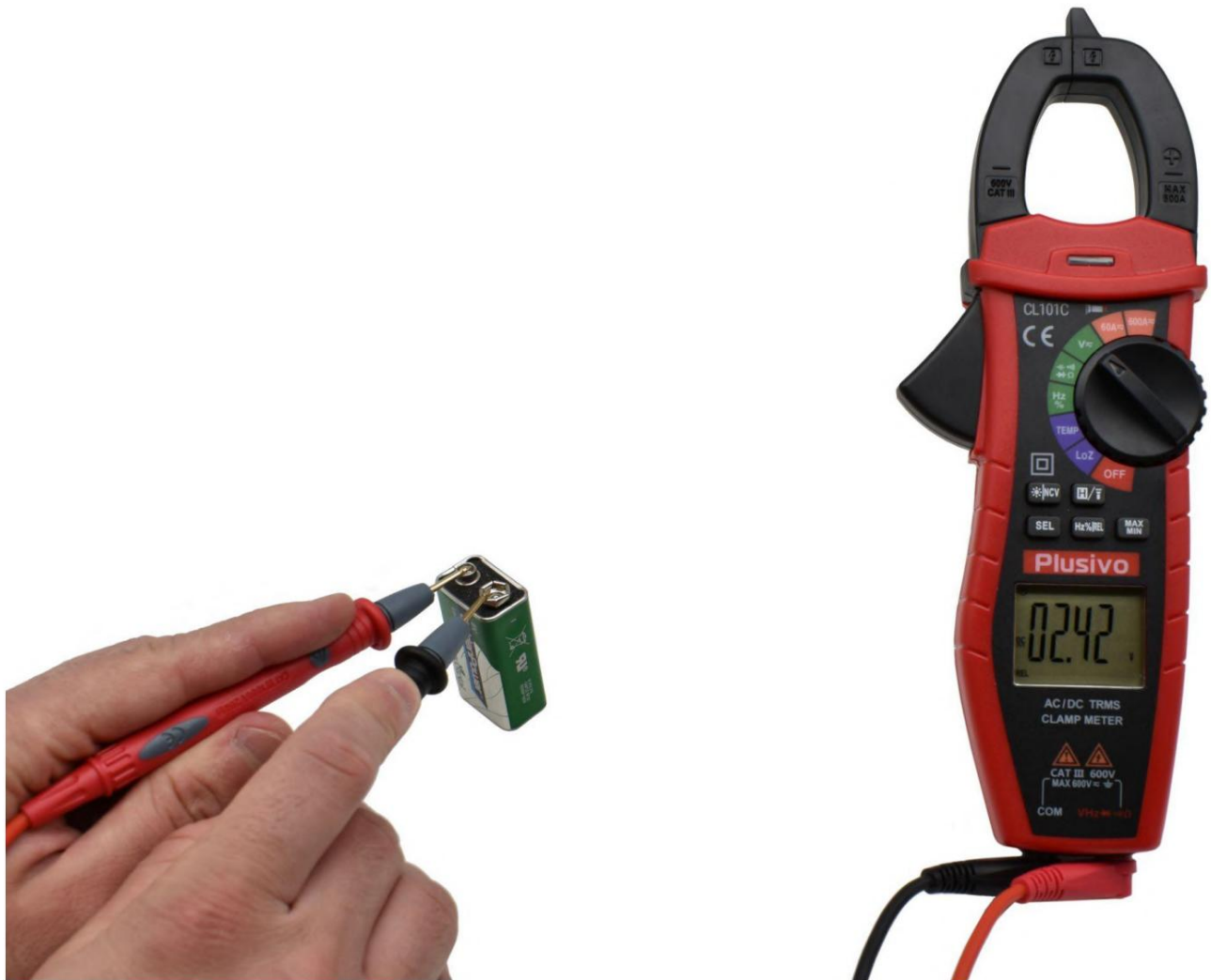
شکل 26. ولتاژ اندازه گیری شده در این شکل 2.42 ولت DC است
