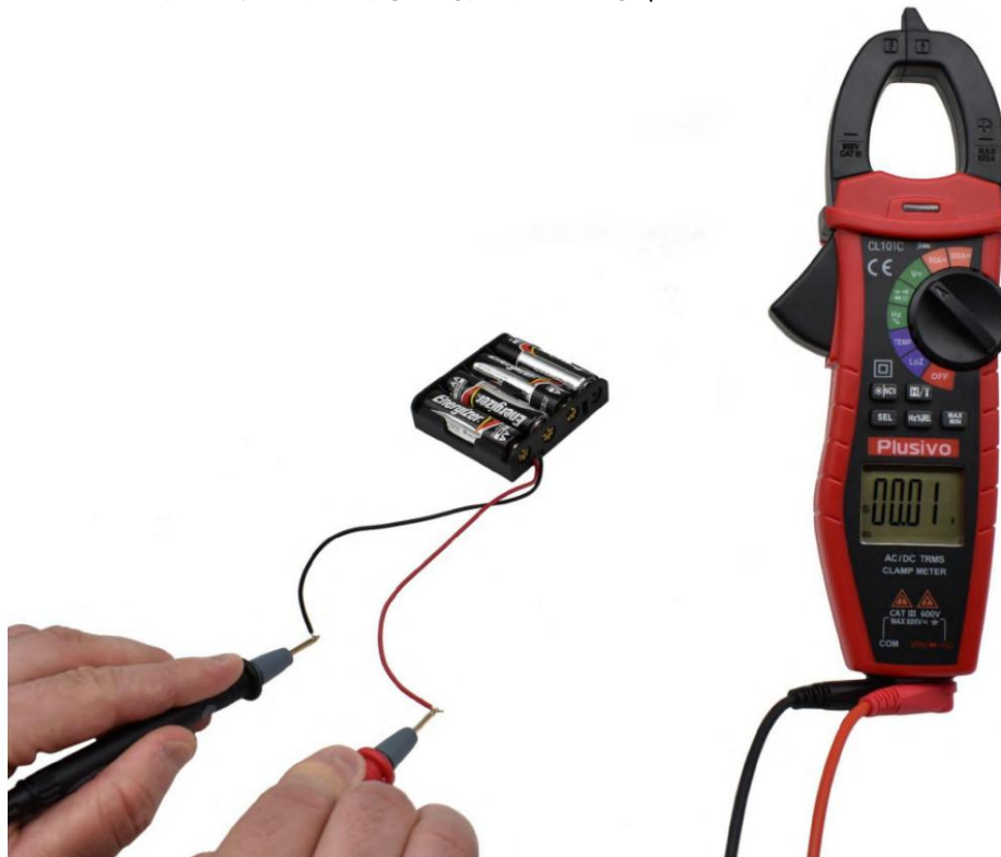
شکل 24. ولتاژ اندازه گیری شده در این شکل 0.01 ولت DC است
