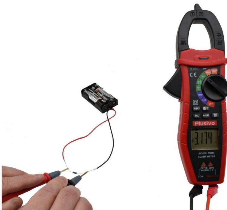
شکل 33. ولتاژ اندازه گیری شده در این شکل 3.174 ولت DC است
