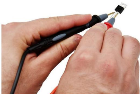
شکل 48. ولتاژ رو به جلو اندازه گیری شده در این شکل 0.649 V است.
