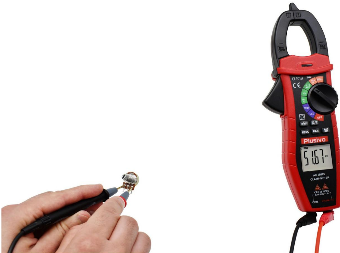
شکل 42. مقاومت اندازه گیری شده در این شکل 51.67 کیلو اهم است
