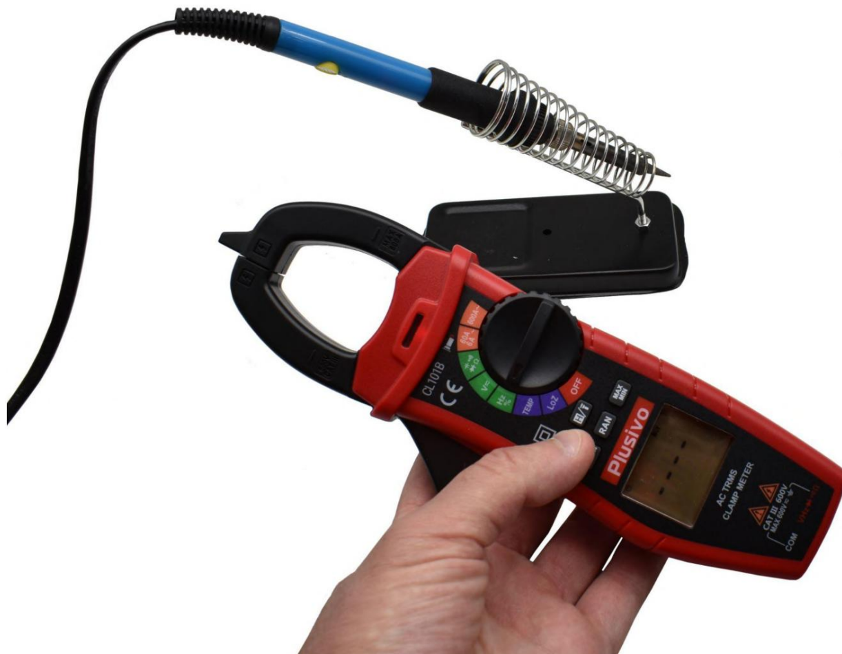
شکل 29. کلمپ متر ولتاژ AC را تشخیص می دهد.
