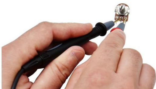
شکل 44. مقاومت اندازه گیری شده در این شکل 40.89 کیلو اهم است
