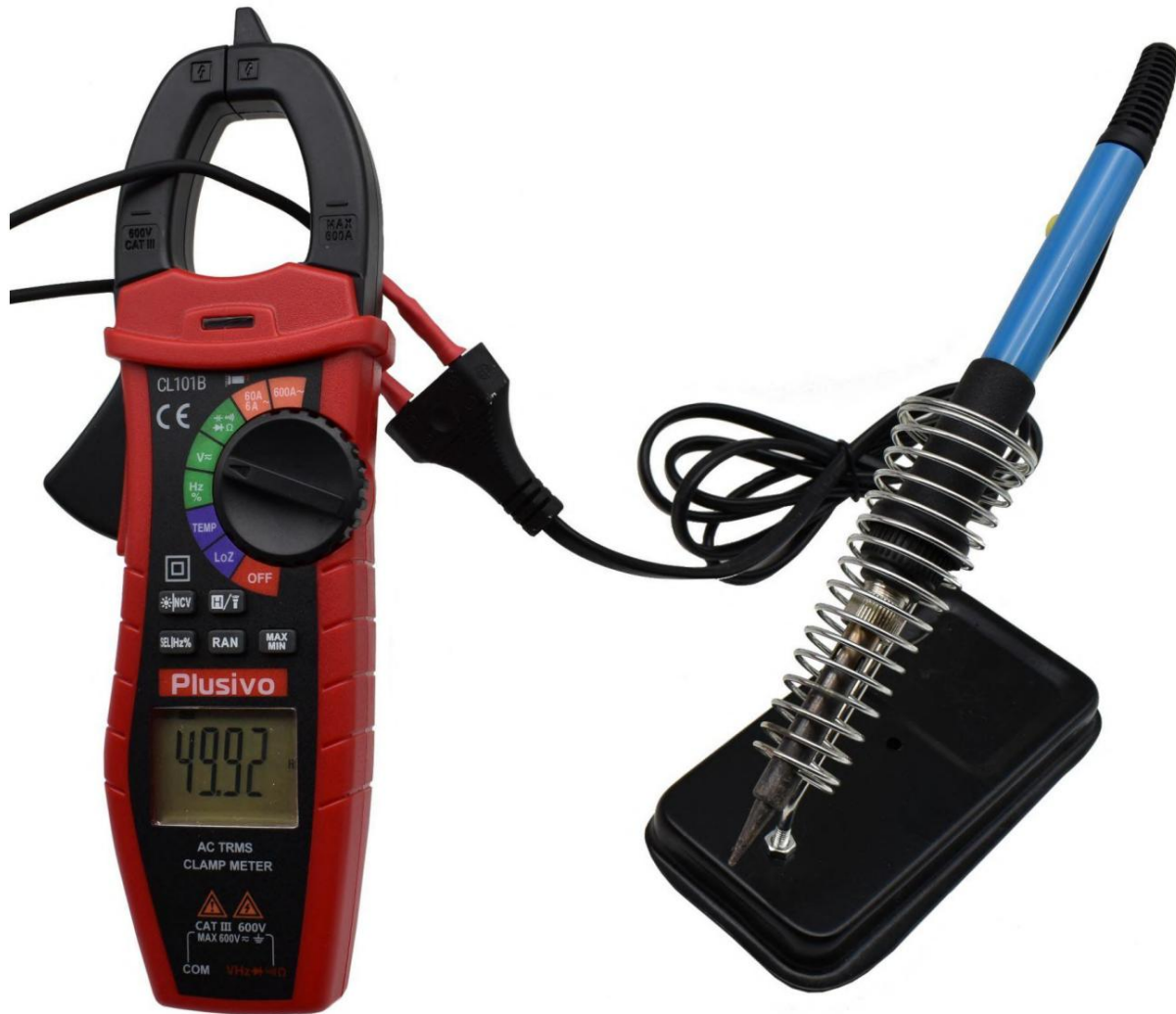
شکل 18. فرکانس اندازه گیری شده در این شکل 49.92 هرتز است
