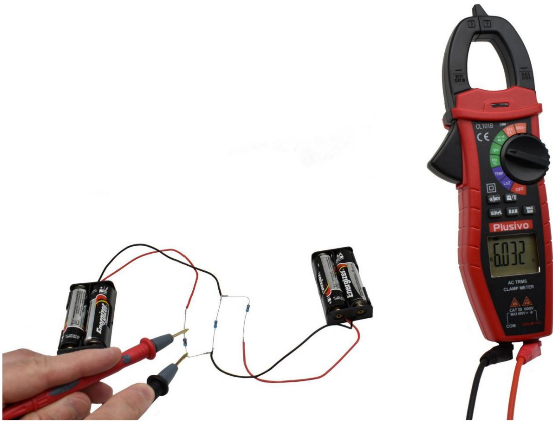
شکل 34. ولتاژ اندازه گیری شده در این شکل DC 6.032 V است
