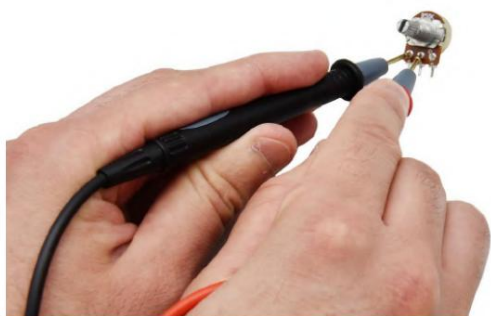
شکل 43. مقاومت اندازه گیری شده در این شکل 11.47 کیلو اهم است
