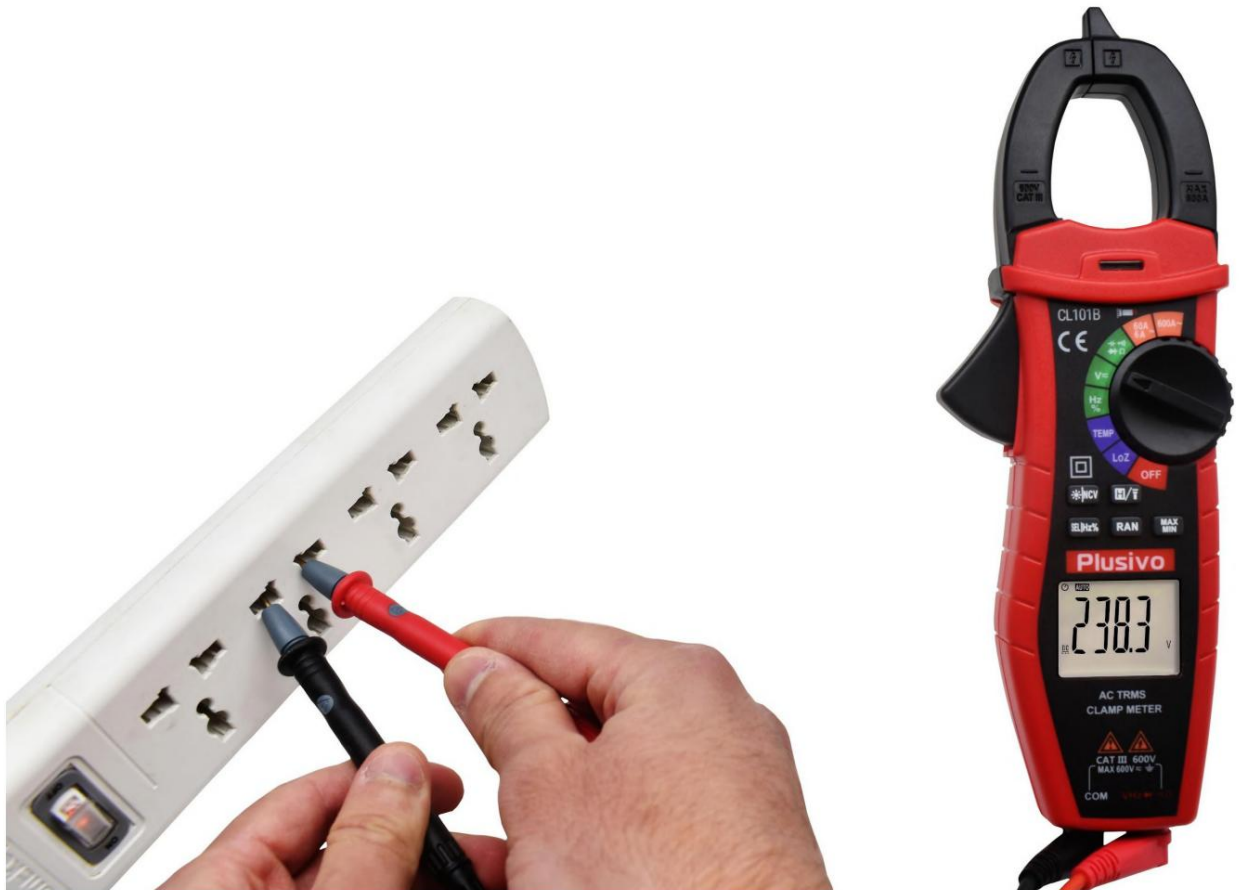
شکل 2. ولتاژ اندازه گیری شده در این شکل AC 238.3 V است
