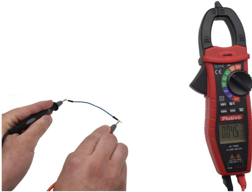
شکل 13. اگر یک مسیر رسانا وصل شود، گیره سنج بوق و آلام می دهد چراغ نشانگر روشن خواهد شد
