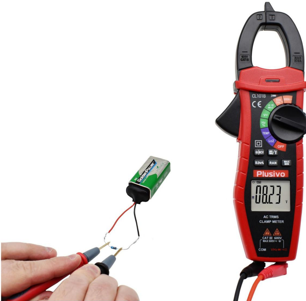
شکل 41. ولتاژ اندازه گیری شده در این شکل 8.23 ولت DC است
