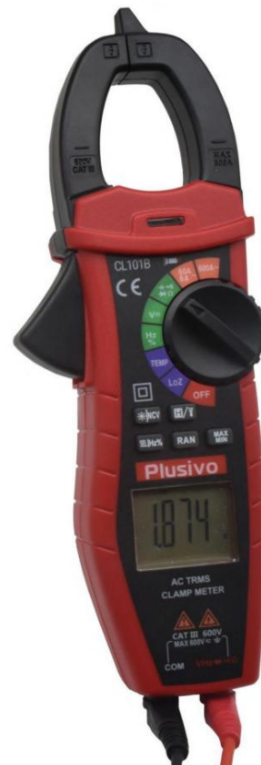
شکل 12. ولتاژ رو به جلو اندازه گیری شده در این شکل 1.874 ولت است
