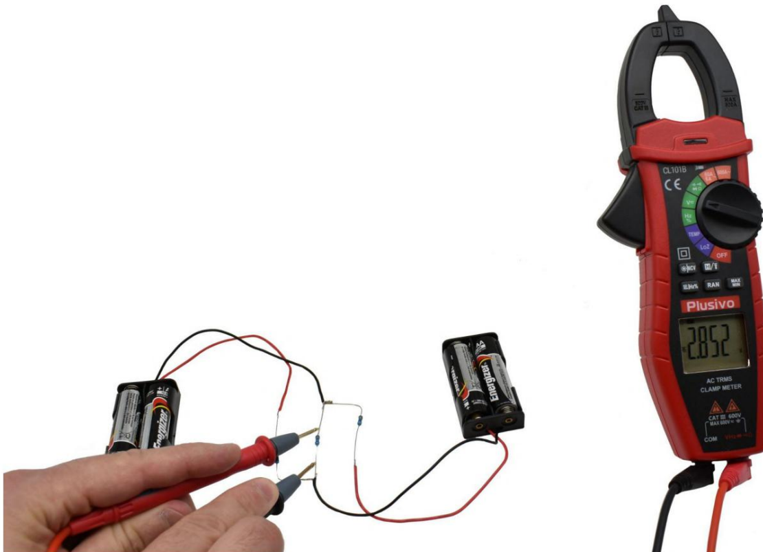
شکل 35. ولتاژ اندازه گیری شده در این شکل DC 2.852 V است
