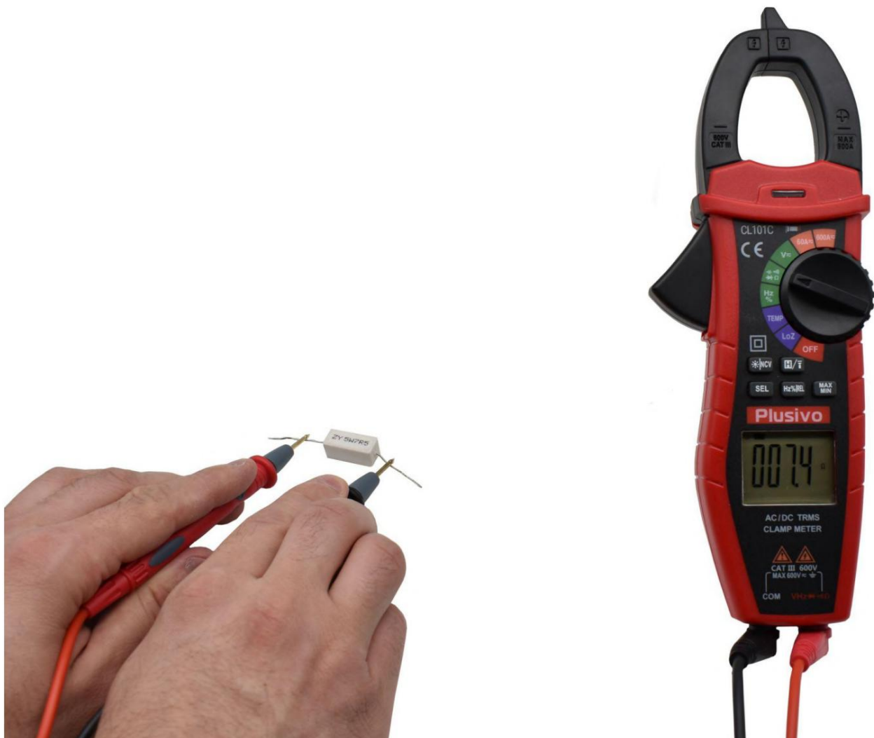
شکل 37. مقاومت اندازه گیری شده در این شکل 7.4\ \Omega است
